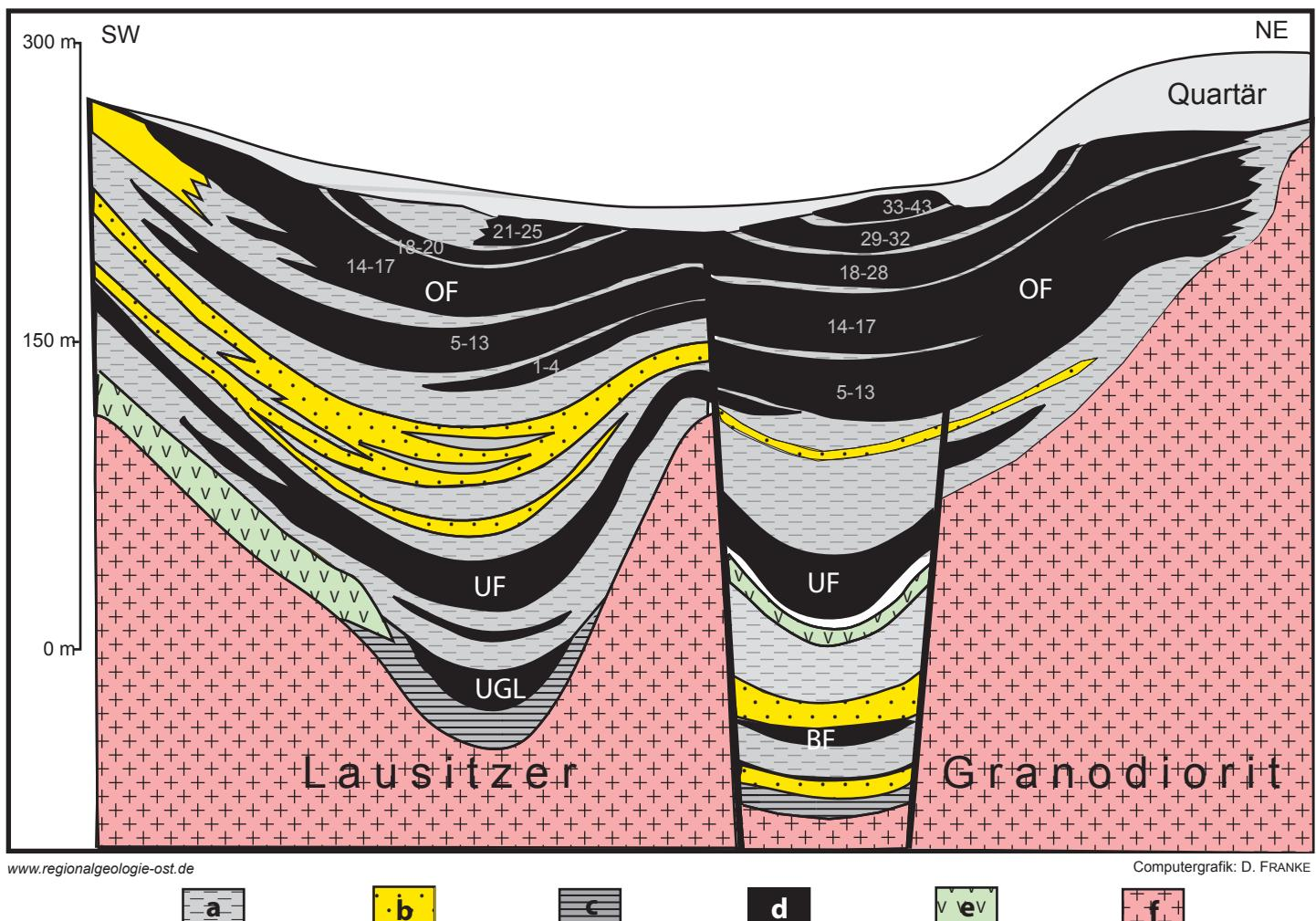
OF - Oberflöz, UF - Unterflöz, UGL - Unterbegleiter Unterflöz, BF - Basalflöz
